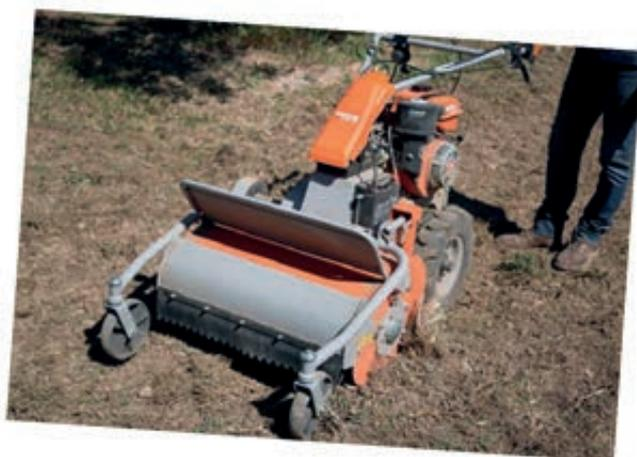
La clave del modelo 704 reside en su cabezal de cuchillas rotativas, diseñado para realizar tareas de siega y trituración simultáneamente. Este sistema permite dejar el terreno completamente limpio en una sola pasada, deshaciendo incluso ramas, rastrojos y vegetación espesa. Gracias a su ancho de corte de 700 mm y su potente motor Weima W300F-2, la máquina ofrece un rendimiento constante y homogéneo.
