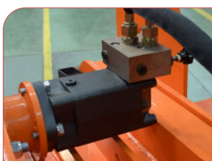
Motor hidráulico regulable del rodillo alimentador.
