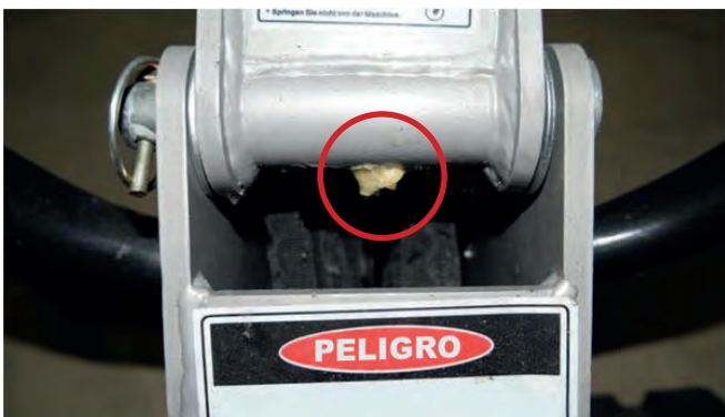
Fig. 17 Tornillo de lubricación bomba principal inferior.
