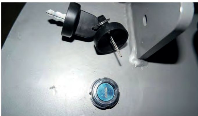
Fig. 34 Llave y cerradura de contacto.
