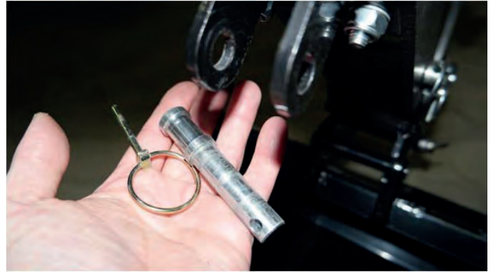
Fig. 50 Soltar perno con pasador
