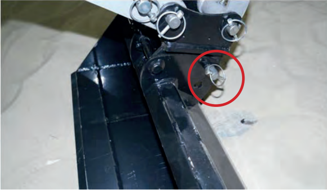
Fig. 25 Perno para soltar
