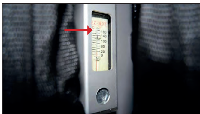
Fig. 2 Nivel correcto del indicador.
