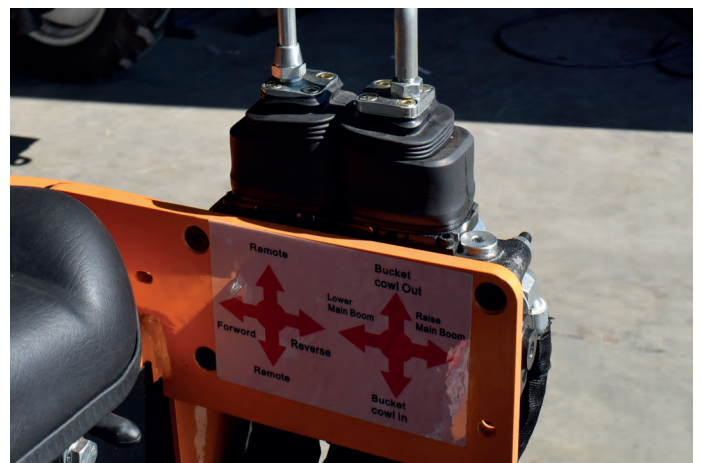
Fig. 33 Etiqueta del control izquierdo.
