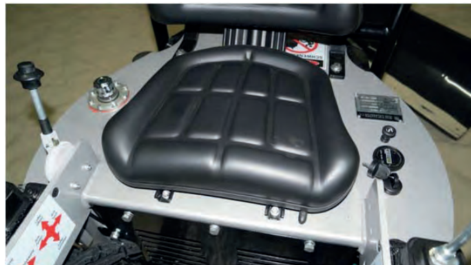
Fig. 24 Asiento con interruptor de contacto.
