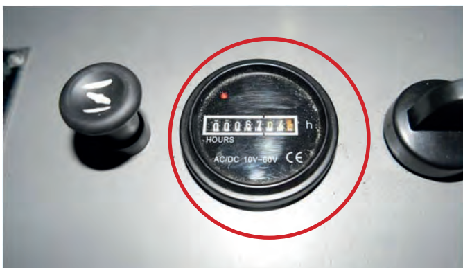
Fig. 35 Contador de horas de funcionamiento.
