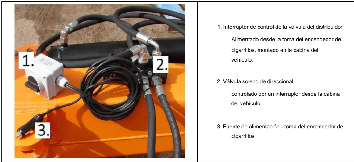
Fig. 7. Elementos del sistema de control hidráulico de la niveladora.
