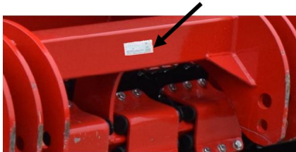
Fig. 1. Ubicación de la placa de características de la grada de discos hidráulica (datos de identificación)
