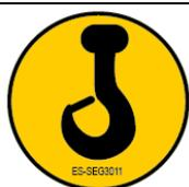
**Para el levantamiento de la máquina mediante grúa utilice ganchos de seguridad o cables con las características adecuadas para insertar en las argollas (cáncamos) preestablecidas de cara al levantamiento indicado por los pictogramas aplicados en la máquina.**
