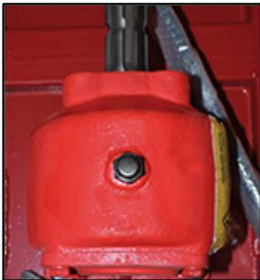
Antes de poner en funcionamiento el apero, lubrique el grupo y el eje de transmisión desenroscando el tornillo de admisión. Rellene el grupo y el eje con aceite de lubricación adecuado.
