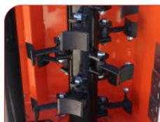
24 martillos en un eje rotor de 78 mm.
