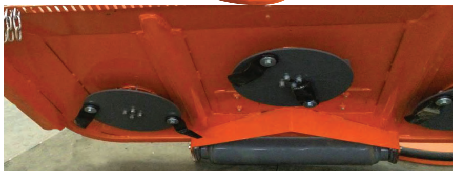
3 Discos de 2 cuchillas: Espesor 8 mm. Longitud 107 mm Anchura 60 mm.
