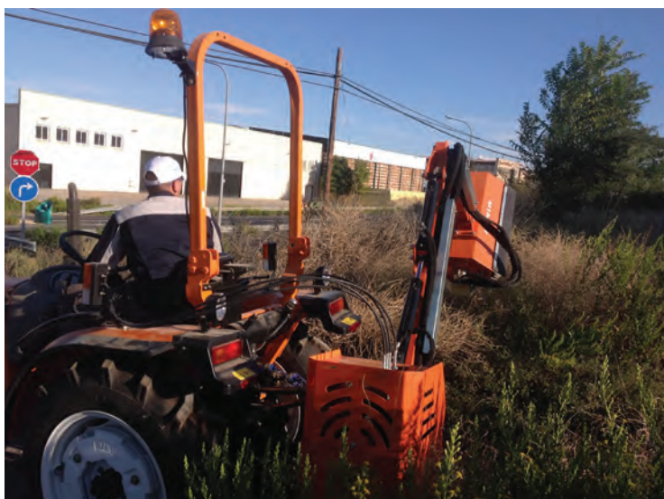
BARRA DE CUCHILLAS CON MOTOR HIDRÁULICO.
