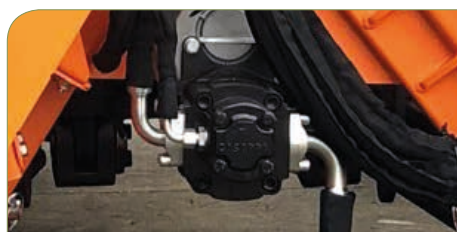
Bomba hidráulica y Multiplicador a PTO. Depósito de 120 litros.
