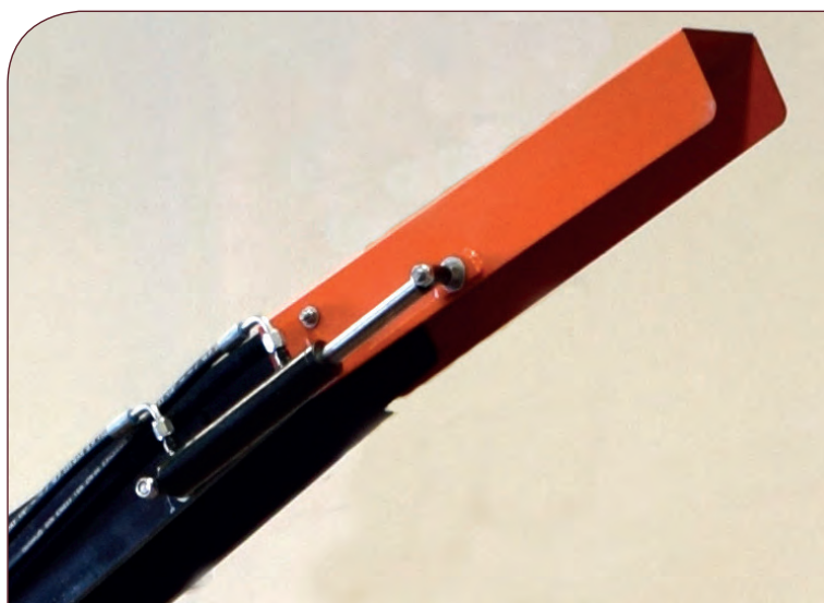
Chimenea regulable por hidráulica al mando.
