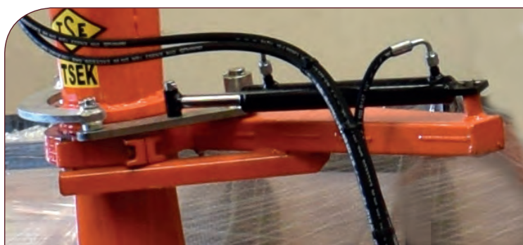
Chimenea regulable por hidráulica al mando.
