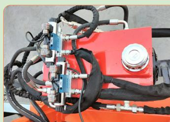
2 electroválvulas de doble efecto y depósito de aceite 45L.
