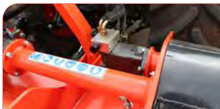
Motor hidráulico regulable.
