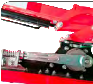
Nuevo modelo con biela reforzada.
