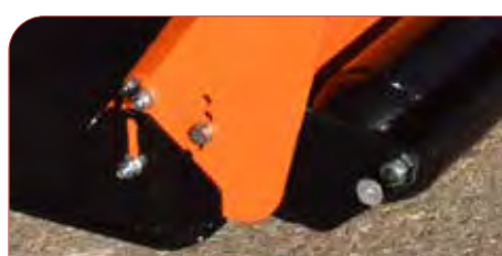
Patines ajustables en altura. Rodillo.
