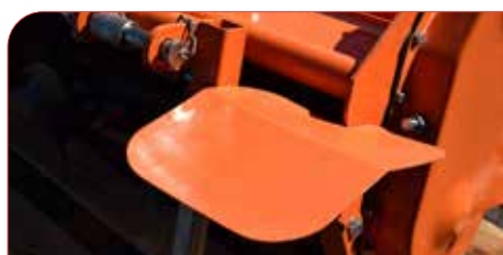
Alerón trasero de seguridad ajustable.
