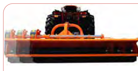
Desplazamiento horizontal de hasta 500 mm. Apertura ajustable
