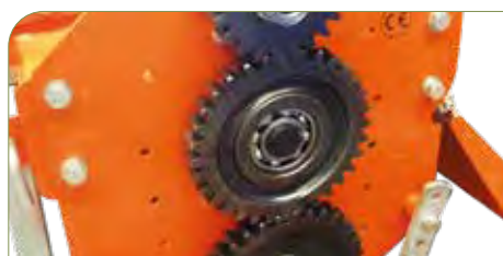
Transmisión por engranajes.
