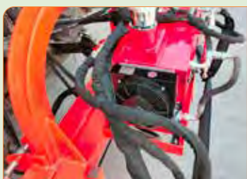
Radiador con termostato.
