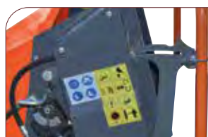
Palanca cambio sentido triturado.
