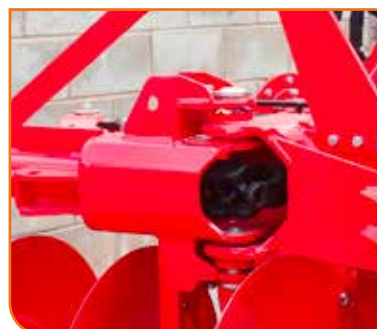
Detalle de cardan interno.
