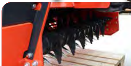
Púas y rodillo alimentador independiente y regulable.
