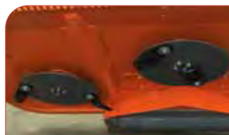
3 Discos de 2 cuchillas: Espesor 8 mm. Longitud 107 mm. Anchura 60 mm.
