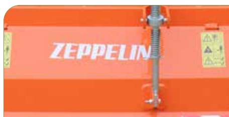
Portón ajustable con amortiguador.
