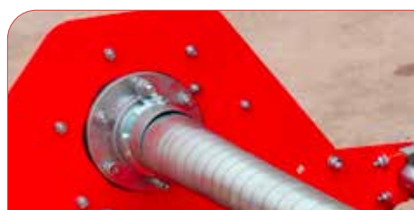
Eje de transmisión desplazable.
