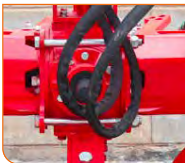
Grupo central de transmisión de potencia.
