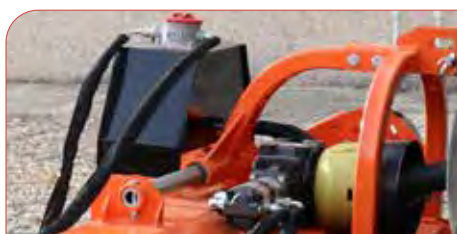
Sistema hidráulico: depósito + doble bomba
