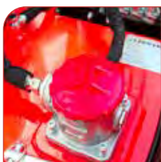
Depósito hidráulico 60L.
