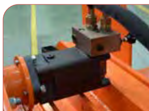
Motor hidráulico regulable del rodillo alimentador.
