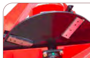
Disco giratorio con 4 Cuchillas.
