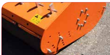
Rastrojeros, patines y rodillo regulables en altura.
