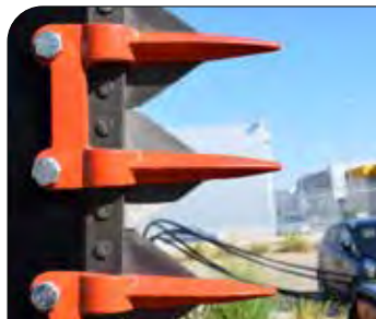
21 secciones dentadas y dobles dedos.
