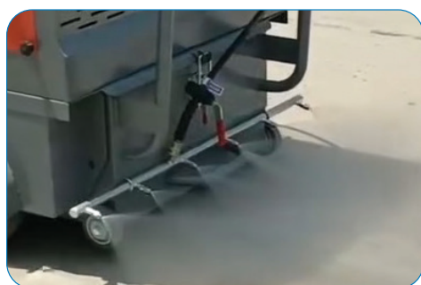
Tren de pulverizado de agua. Depósito de agua de 50L.
